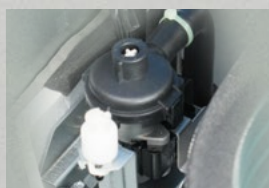
Новая помпа сниженный шум и вибрация
