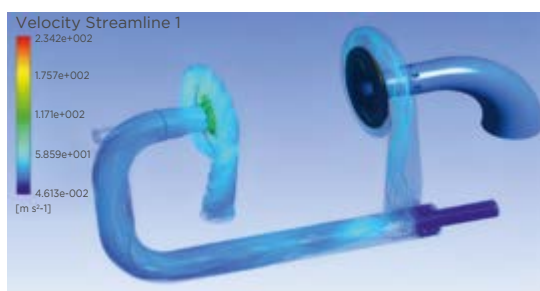
Анализ поля потока при последовательном двухступенчатом сжатии
